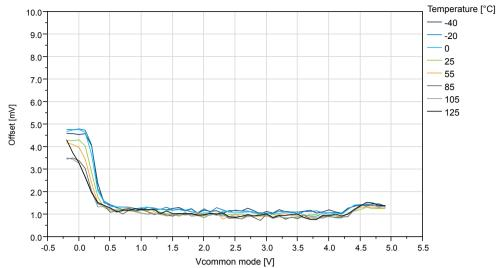
Figure 35-55. Offset vs. V<sub>CM</sub> - 10mV to 50mV (V<sub>DD</sub>=5V, T=25°C)
