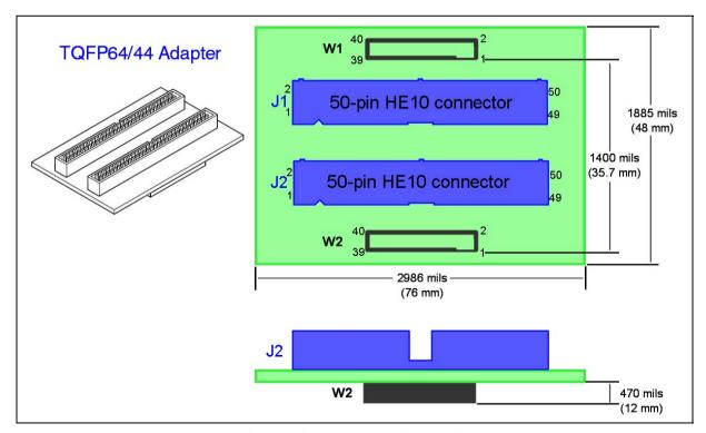
Figure 15: TQFP64/44 adapter (DB612) dimensions
